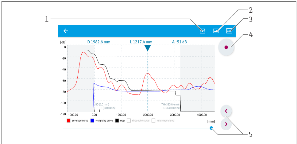
図 20 SmartBlue での反射波形表示 (例) ; Android の表示
