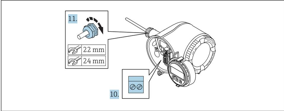
10. Conecte los cables conforme a la asignación de terminales.
