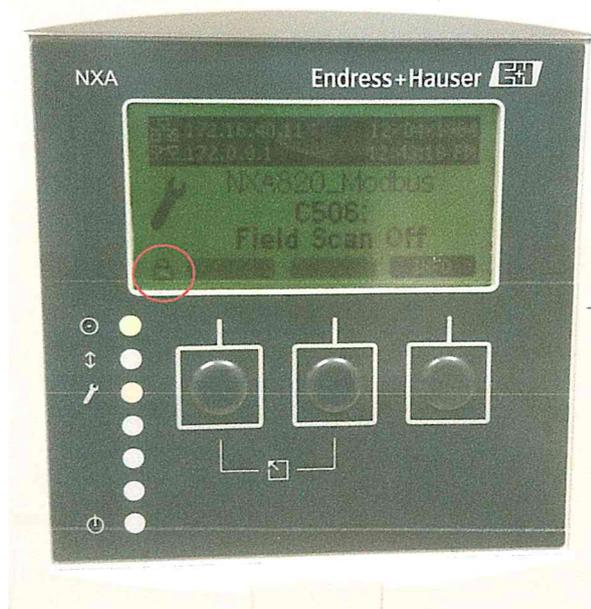
Abb. 32: Eichstatus auf dem Display eines Tankvision-Geräts
