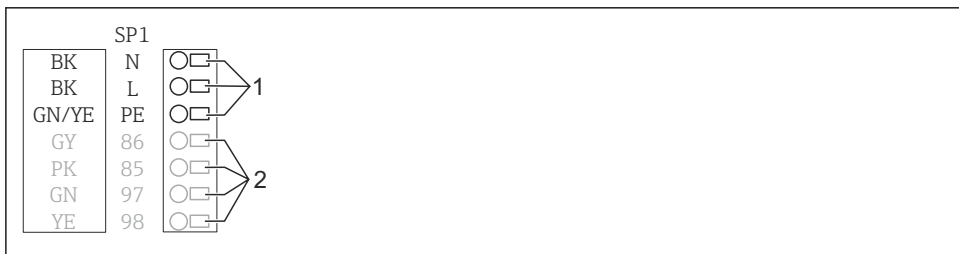
8 Diagrama de fiação para a válvula de limpeza no Liquiline System CA80
