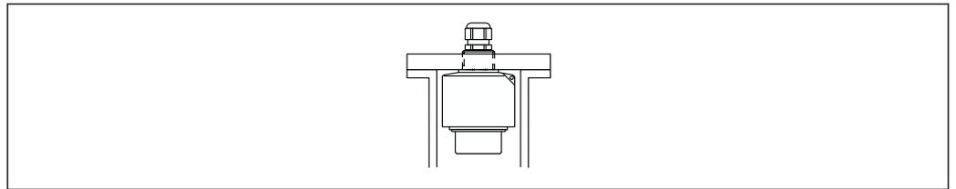
7 Fissaggio del sensore a ultrasuoni; montato con controdado
