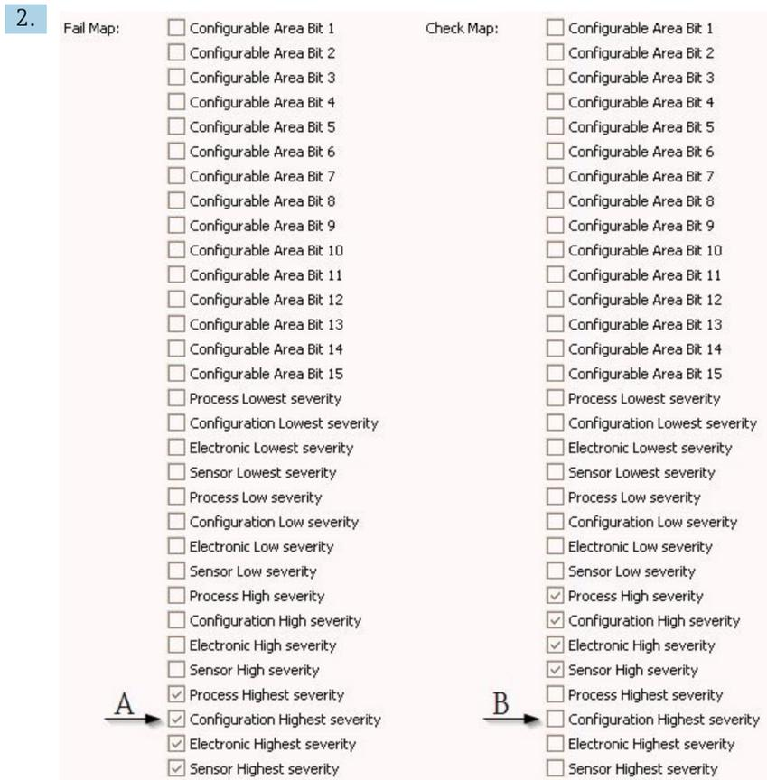
Fig. 27 Estado por defecto de las columnas "Fail Map" y "Check Map"
