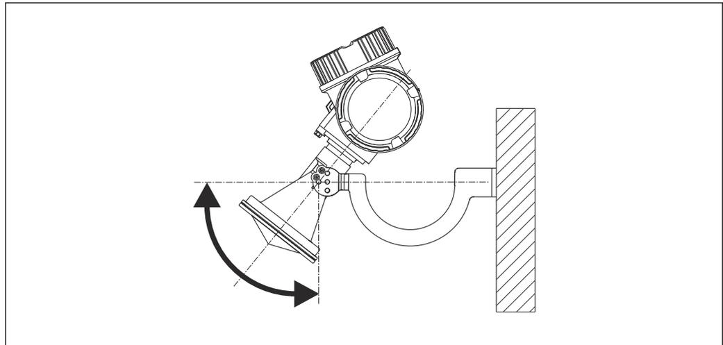
7 Instalação da antena piramidal com suporte de montagem
