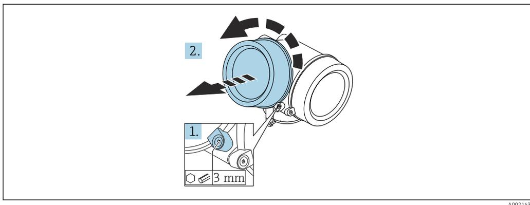
1. Solte o parafuso da braçadeira de segurança da tampa do compartimento de componentes eletrônicos usando uma chave Allen (3 mm) e girando a braçadeira 90° no sentido anti-horário.
