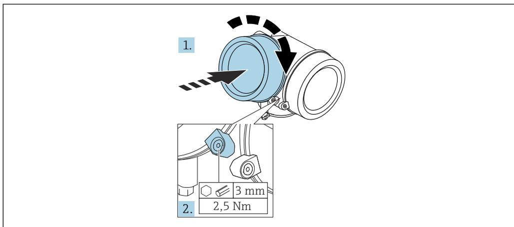
1. Parafusar a tampa do compartimento dos componentes eletrônicos novamente.
