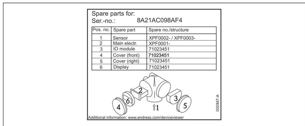
28 Exemplo de uma etiqueta de identificação de peça sobressalente na tampa do compartimento de conexão
