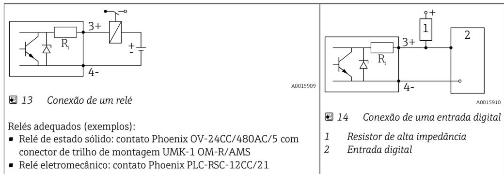
**i** Para imunidade a interferência otimizada, recomendamos conectar um resistor externo (resistência interna do relé ou resistor de alta impedância) de  $< 1\,000\ \Omega$ .
