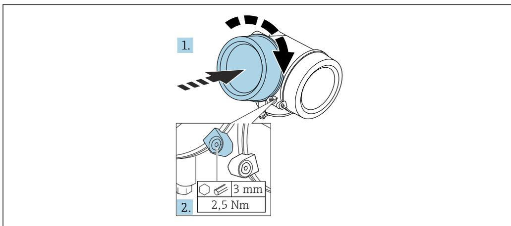
1. Плотно заверните крышку отсека электронной части.
