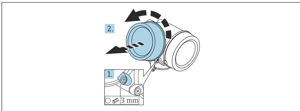
1. Ослабьте винт зажимного хомута крышки отсека электронной части с помощью шестигранного ключа (3 мм) и поверните хомут на 90 град против часовой стрелки.
