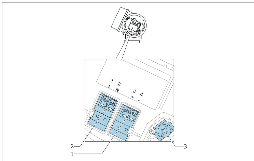
10 Назначение клемм, 4-проводное подключение; 4–20 мА HART (90 до 253 V<sub>AC</sub>)
