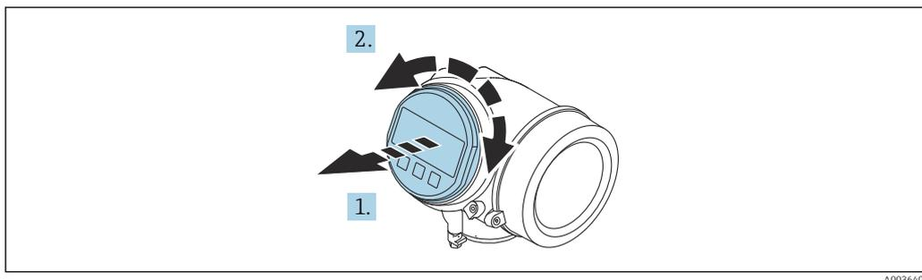
1. Плавным вращательным движением извлеките дисплей.
