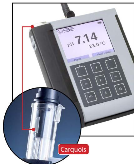
Le **Liqiline To Go CYM290** est un appareil de mesure multiparamètres pour l'utilisation de sondes analogiques et numériques. L'appareil reconnaît automatiquement le raccordement de sondes Memosens et bascule automatiquement au paramètre adapté. Il suffit de changer de sonde Memosens pour mesurer la **conductivité**, le **pH** ou l'**oxygène**. L'utilisation est simple et intuitive grâce aux textes d'info et d'aide complets.
