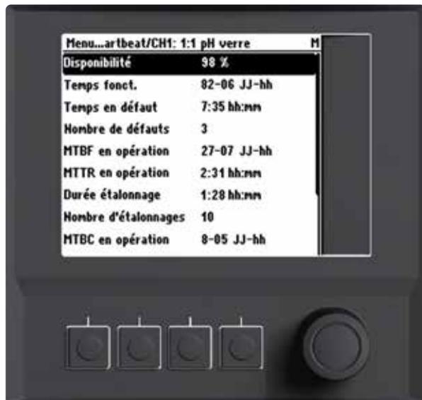
Ces KPI sont par exemple la disponibilité du point de mesure, les temps de fonctionnement, le temps moyen entre les pannes en fonctionnement (MTBF), le temps moyen de réparation en fonctionnement (MTTR) et bien d'autres encore. Des informations détaillées sont disponibles dans le chapitre "Glossaire".
