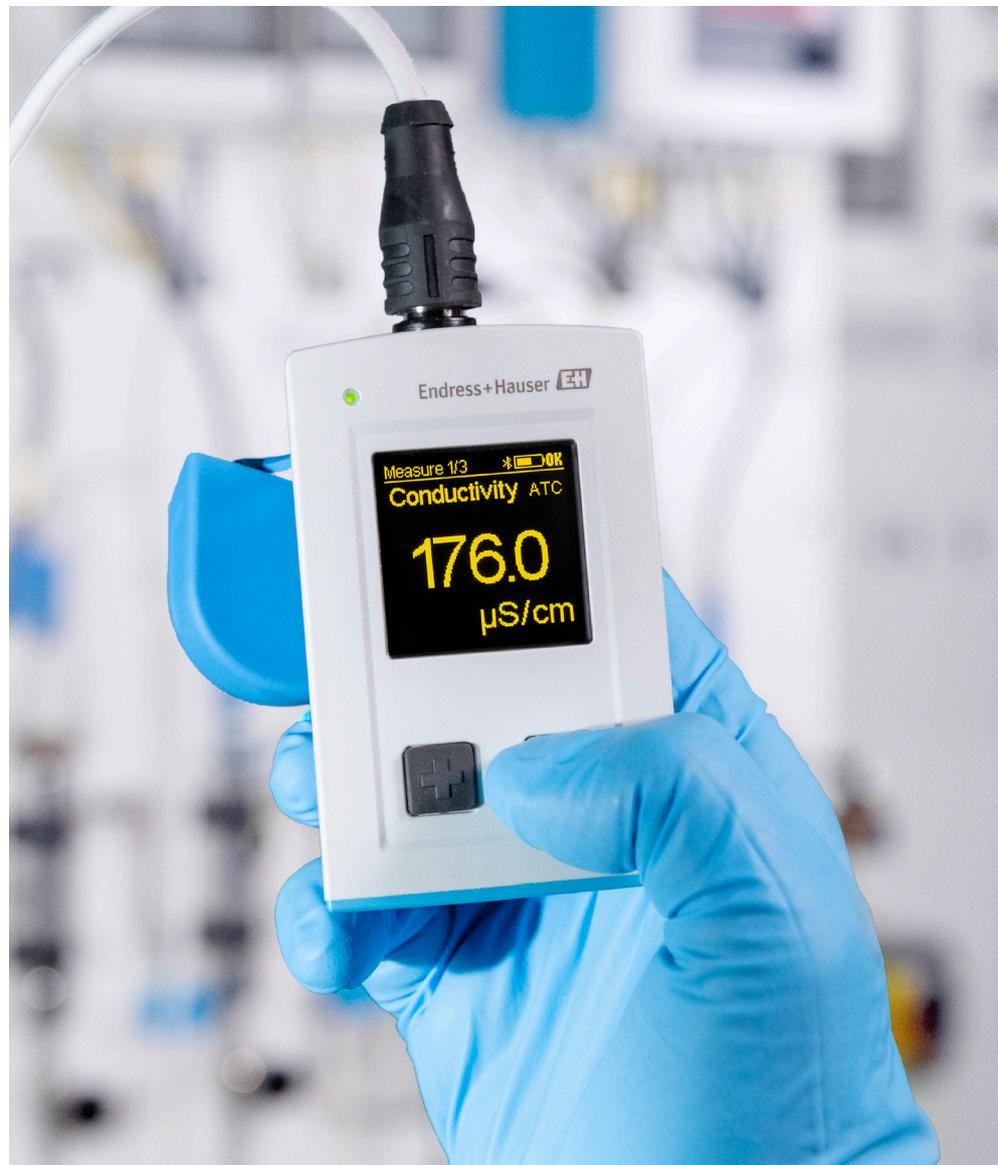
Il palmare multiparametro Liquiline Mobile CML18 misura pH/redox, conducibilità e ossigeno con la massima affidabilità. Può essere utilizzato in qualsiasi punto di misura del sistema per stabilire immediatamente cosa sta succedendo nel processo.
