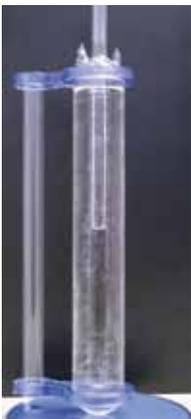
Celda para calibración en punto triple
