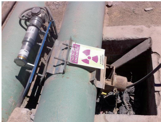
Abbildung 4: Aufbau mit neuem Detektor und alter Strahlungsquelle
