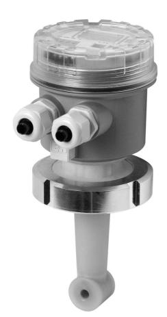
Der kompakte Messumformer SmarTec M CLD 133 dient zur induktiven Leitfähigkeitsmessung in Flüssigkeiten mittlerer bis hoher Leitfähigkeit, wie z.B. zur Steuerung und Überwachung bei der CIP-Reinigung. Der Messumformer kann in Temperaturbereichen bis 100 °C eingesetzt werden.
