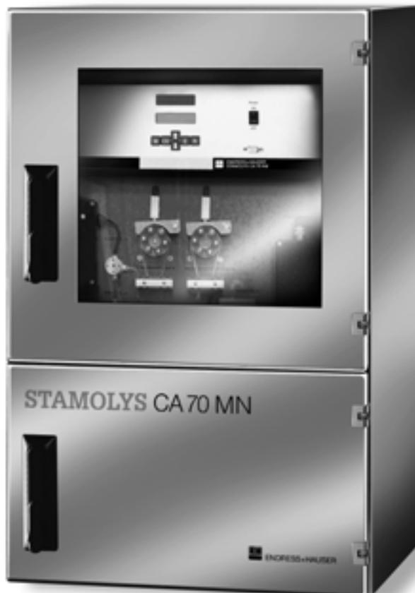
Der Stamolys Analysator CA 70 MN ist ein kompaktes Analysesystem für geringe Mangankonzentrationen zum Einsatz in Trinkwasser- und Abwasseranlagen. Die Bestimmung des Mangans erfolgt nach dem photometrischen Messprinzip.
