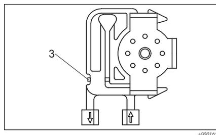
Abb. 23: Probenpumpe
