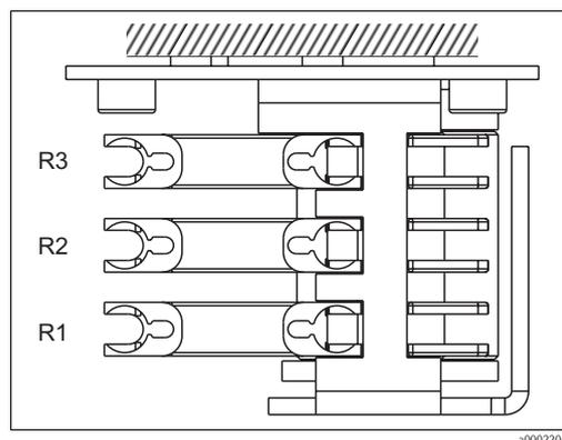
Fig. 22 : Pompe à réactifs, vue d'en haut
