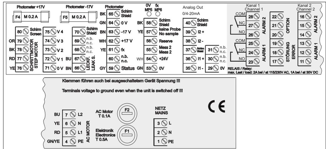
Fig. 16 : Exemple d'étiquette de raccordement
