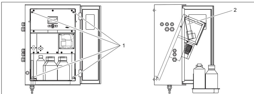
Fig. 15: Pivotement du cadre
