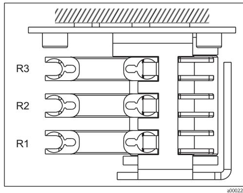
Fig. 12 : Pompe à réactifs, vue d'en haut
