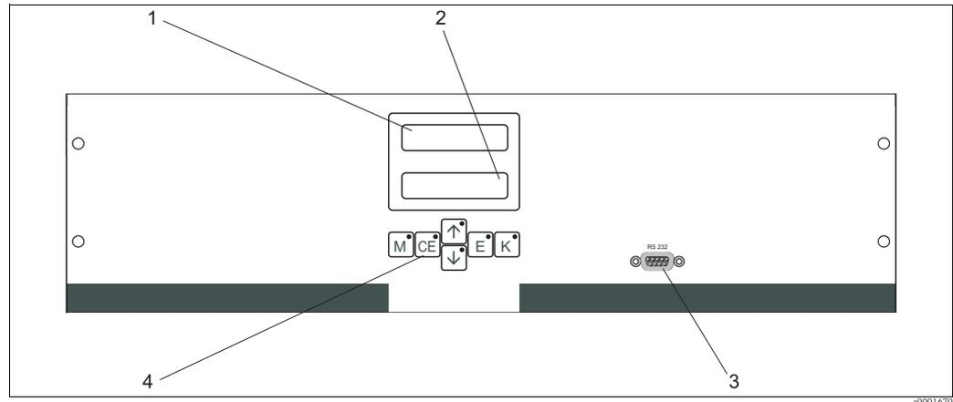
Fig. 19 : Éléments d'affichage et de configuration
