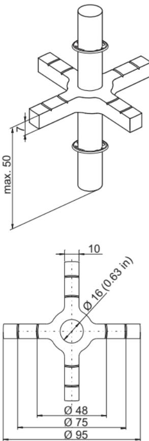
Mesurez le diamètre du tube de mesure ou du bypass et adaptez le disque de centrage en conséquence. Les repères sur le disque de centrage à 4 branches facilitent la découpe. Pour cela, utilisez une scie à métaux ou une pince coupante diagonale. Le disque de centrage doit être monté à l'extrémité inférieure de la tige de sonde à une distance maximale de 50 mm de l'extrémité. Déterminez l'endroit où doit être placé le disque de centrage et marquez-le.
