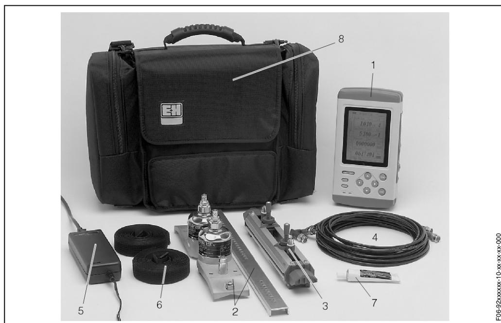
1 = Transmetteur Prosonic Flow 92; 2 = Capteurs Prosonic Flow W, supports de capteur et rail de montage; 3 = Capteur Prosonic Flow U; 4 = Câble de liaison capteur; 5 = Alimentation; 6 = Colliers de serrage; 7 = Pâte de couplage; 8 = Sac de transport
