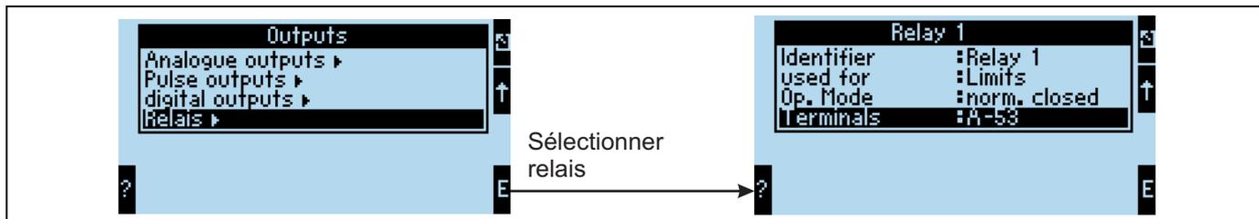
Fig. 46 : Paramétrage des relais
