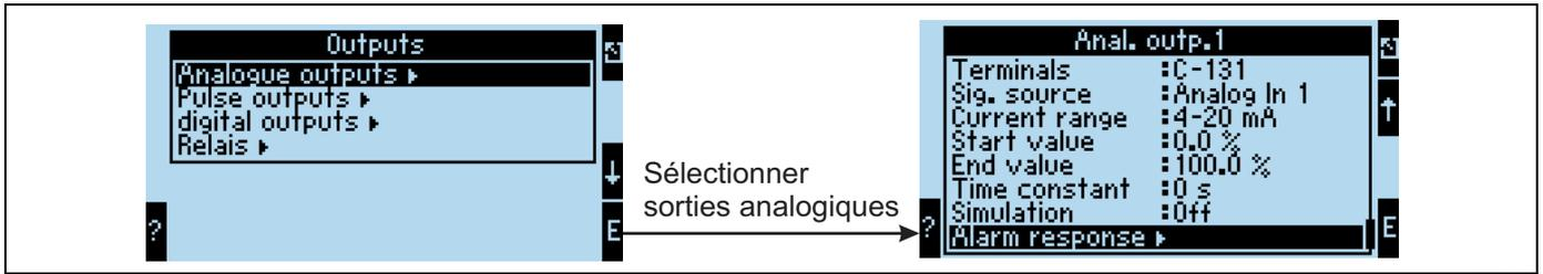
Fig. 43 : Paramétrage de la sortie analogique
