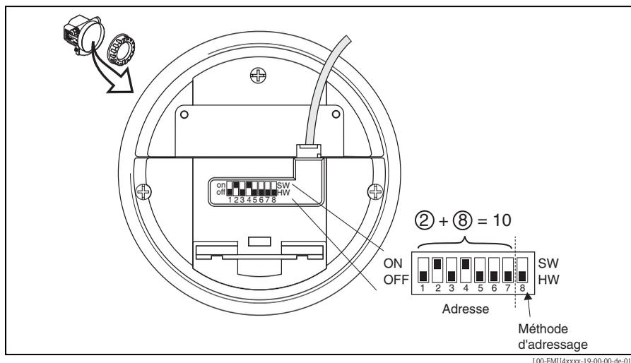
L'adressage hardware est utile lorsque le commutateur DIP 8 se trouve en position "HW (OFF)". L'adresse est alors déterminée par les commutateurs DIP 1 à 7 selon le tableau suivant :
