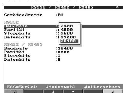
Es ist nun möglich die serielle Schnittstelle RS232 bzw. RS485 mit 38400 bit/s zu betreiben. Mit der Einschränkung, dass die RS232 und RS485 gleichzeitig beide 19200 bit/s oder beide 38400 bit/s haben. Eine Kombination ist nicht möglich.
