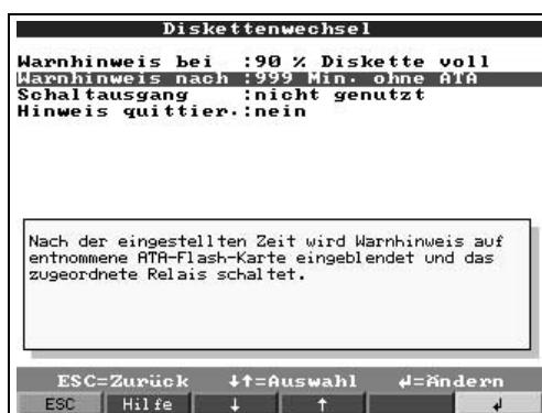
Nach Entfernen der ATA-Flash-Karte aus dem Gerät kann nach einer einstellbaren Zeitdauer von 1-999 Minuten ein Warnhinweis eingeblendet werden.
