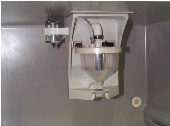
Neue Dosiereinheit, mit Sicherheitsabschaltung LF2 im Pneumatiksystem.
