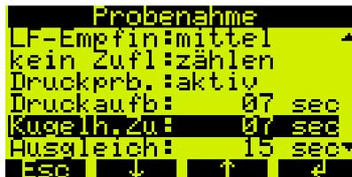
Unter Setup – Geräteeinstellungen – Probenahme – Druckprb. kann die Option aktiviert werden.
