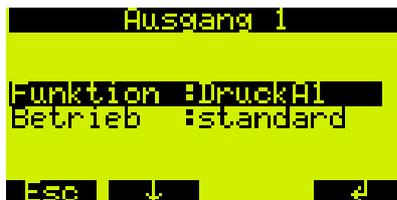
Unter Setup – Geräteeinstellungen – Ausgänge – Ausgang 1-3 kann der Ausgang Druck A1 angewählt werden.
