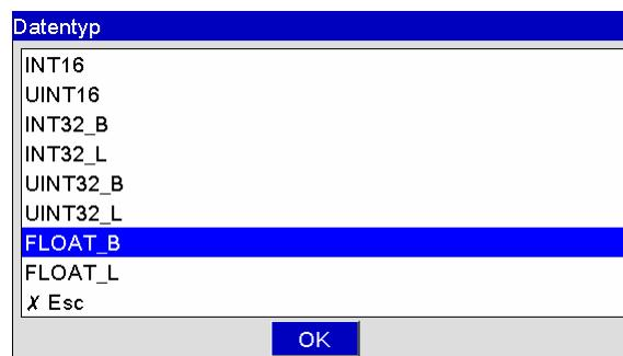
In der MODBUS Spezifikation ist die Adressierung der Bytes, d.h. die Übertragungsreihenfolge der Bytes nicht festgelegt. Es ist deshalb wichtig die Adressierungsweise zwischen Master und Slave bei der Inbetriebnahme abzustimmen bzw. anzugeleichen.
