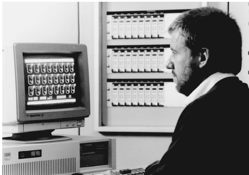
Commutec-Bedienprogramme erlauben die Steuerung von kleinen und mittelgroßen Anlagen durch einen Personal-Computer
