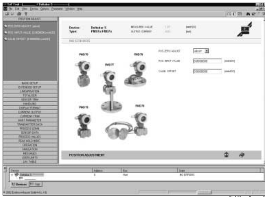
Fig. 33: Programul de operare ToF Tool, configurarea este realizata prin meniu
