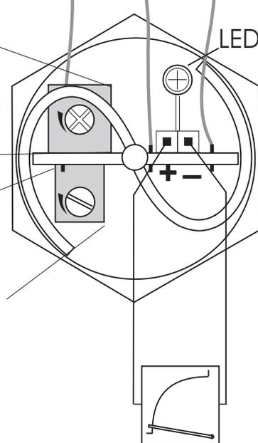
**p** \* Voltmeter podłączyć do zacisku kontrolnego za pomocą dostarczonego przewodu kontrolnego
