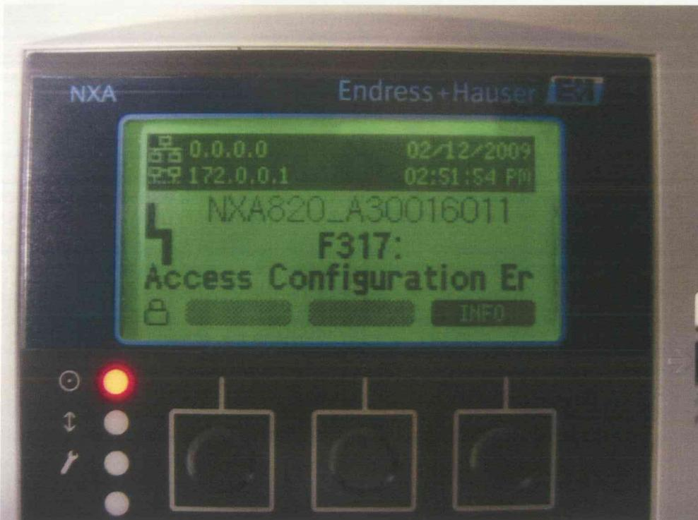
Abbildung 11: Fehlermeldung kein PC am System registriert
