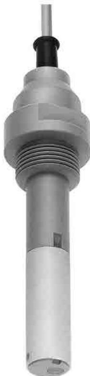
Tato kompaktní čidla pro měření vodivosti byla zkonstruována speciálně pro měření vysoké vodivosti. Měřicí čidla s teplotním snímačem Pt 100 se používají ve spojení s měřicími přístroji vodivosti řady Mycom, Liquisys a MyPro, vybavenými automatickou teplotní kompenzací.
