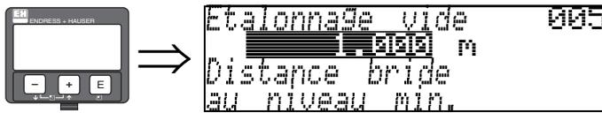
Cette fonction permet d'entrer la distance entre la bride (point de référence de la mesure) et le niveau minimal (=point zéro).
