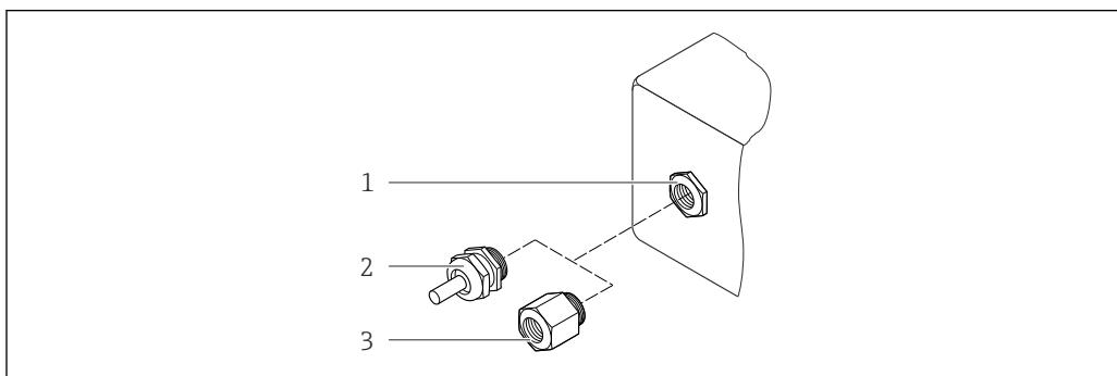
图 32 允许的电缆入口/缆塞
