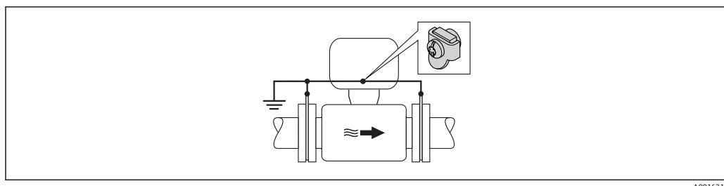
图 17 通过接地端子和接地环实现系统电势平衡
