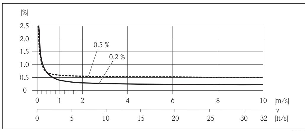
图 31 最大测量误差(% o.r.)示意图
