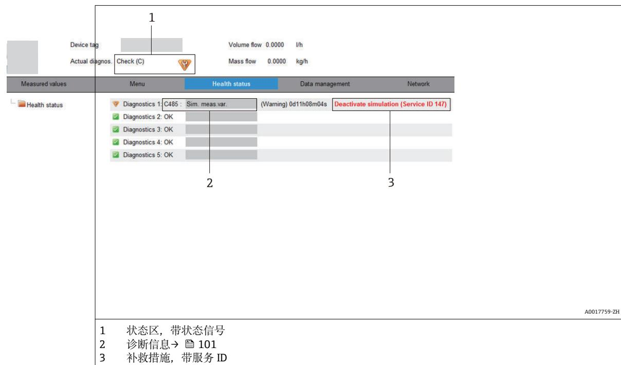
**i** 此外，可以在**诊断**菜单中查看已发生的诊断事件：
