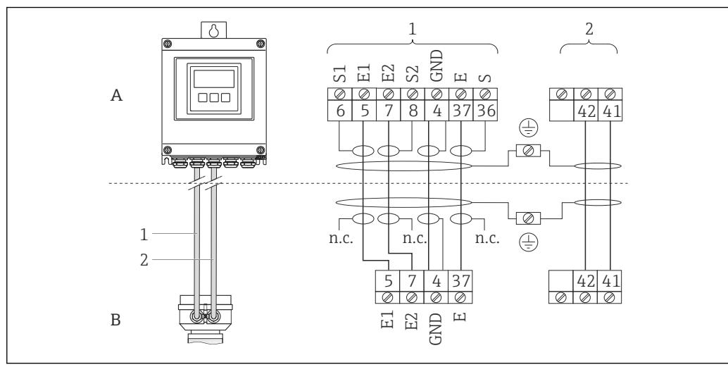
图 9 分体式仪表的接线端子分配示意图
