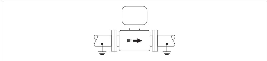
图 15 通过测量管实现电势平衡
