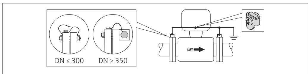
图 16 通过接地端子和管道法兰实现系统电势平衡
