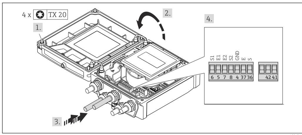
图 12 变送器：带接线端子的主要电子模块
