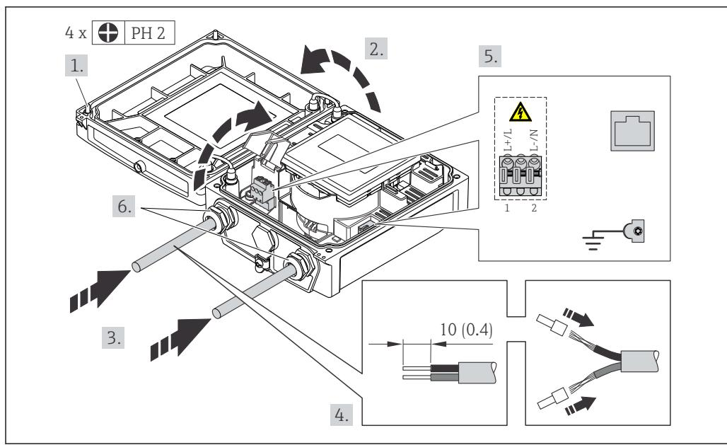
图 14 连接供电电压和工业以太网(EtherNet/IP)
