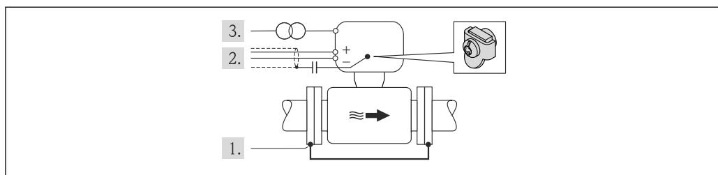
前提：在管道中安装传感器，确保电气绝缘。
