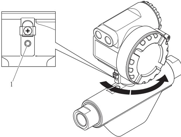
El cabezal del transmisor puede girarse en sentido contrario al de las manecillas del reloj y de forma continua hasta 360°.
