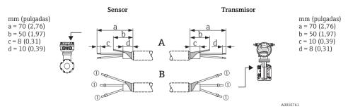
1 = Terminales de empalme de extremo del cable, rojo,  $\emptyset$  1,0 mm (0,04");
