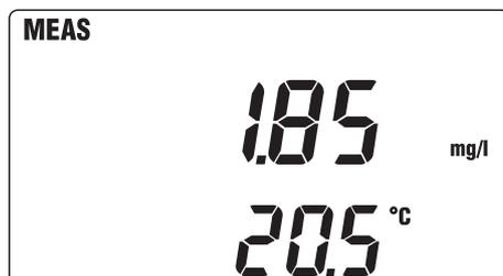
Nach dem Einschalten durchläuft das Gerät einen Selbsttest und geht anschließend in den Meßmodus.
