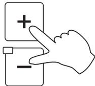
Rücksprung in den Meßmodus durch gleichzeitiges Drücken der Tasten '+' und '-'. Der Hold-Zustand ist aufgehoben.
