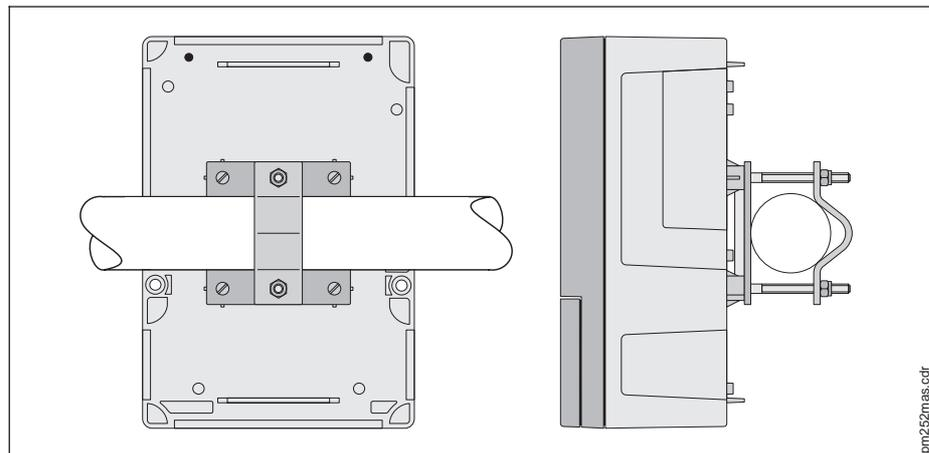
Bild 4.2 Mastmontage Liquisys COM 252
