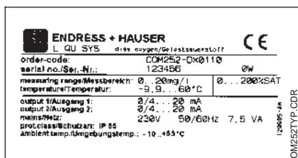
Anhand des Bestellcodes auf dem Typenschild des Gerätes können Sie die Gerätevariante und die Art der vorgesehenen Stromversorgung identifizieren.
