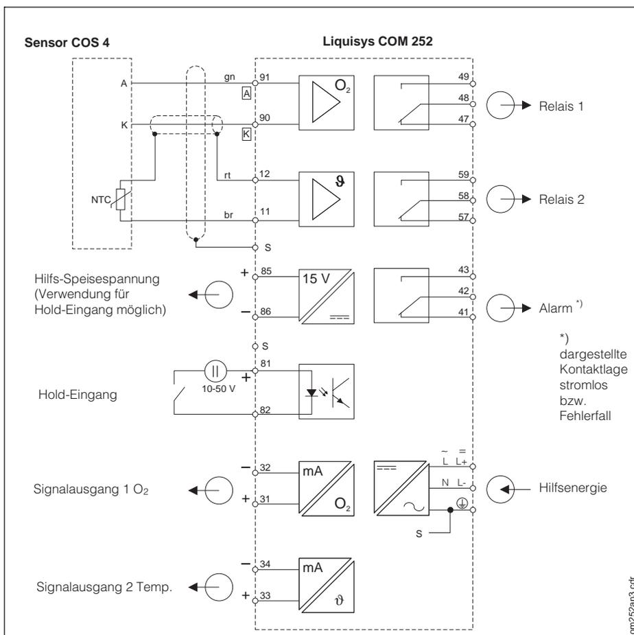
Bild 4.6 Elektrischer Anschluß von Liquisys COM 252
