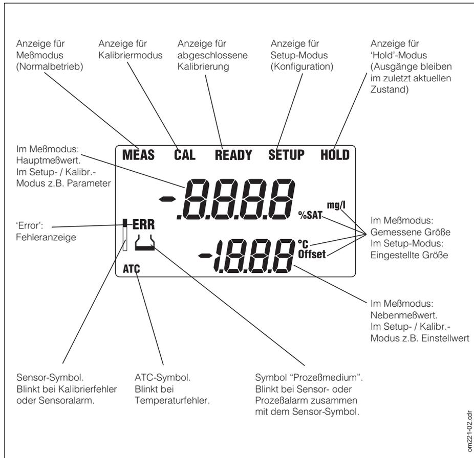
Bild 6.2 Flüssigkristall-Anzeige Liquisys COM 252
