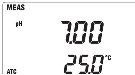
Nach dem Einschalten durchläuft das Gerät einen Selbsttest und geht anschließend in den Meßmodus. Wenn die Anzeige so ähnlich aussieht wie in Bild 5.1, funktioniert das Gerät augenscheinlich fehlerfrei.
