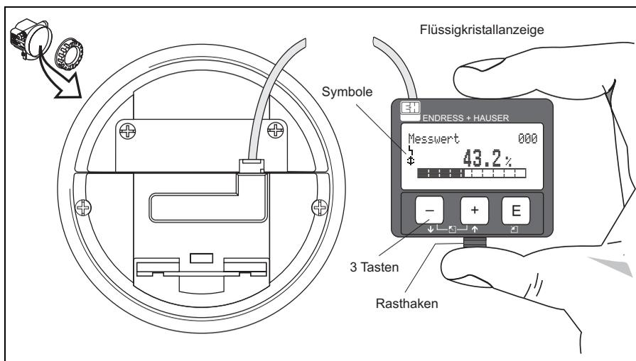
Die LCD-Anzeige kann zur einfachen Bedienung durch Drücken des Rasthakens entnommen werden (siehe Abb.). Sie ist über ein 500 mm (19.7 in) langes Kabel mit dem Gerät verbunden.
