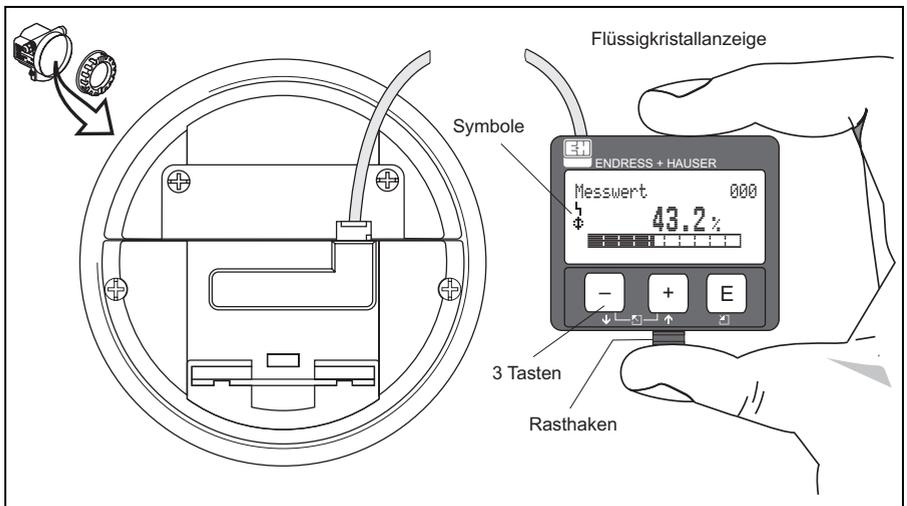
Die LCD-Anzeige kann zur einfachen Bedienung durch Drücken des Rasthakens entnommen werden (siehe Abb.). Sie ist über ein 500 mm (19.7 in) langes Kabel mit dem Gerät verbunden.
