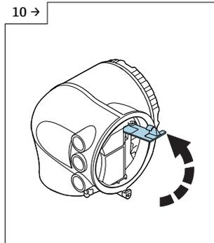
► 1. Ausbau T-DAT, Messumformer in explosionsgeschützter Ausführung
