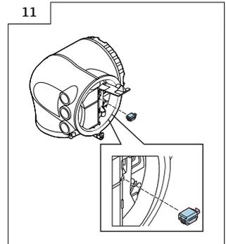
► 2. Ausbau T-DAT, Messumformer in explosionsgeschützter Ausführung
