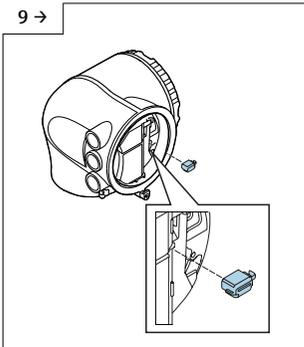
► Ausbau T-DAT, Messumformer in nicht explosionsgeschützter Ausführung
