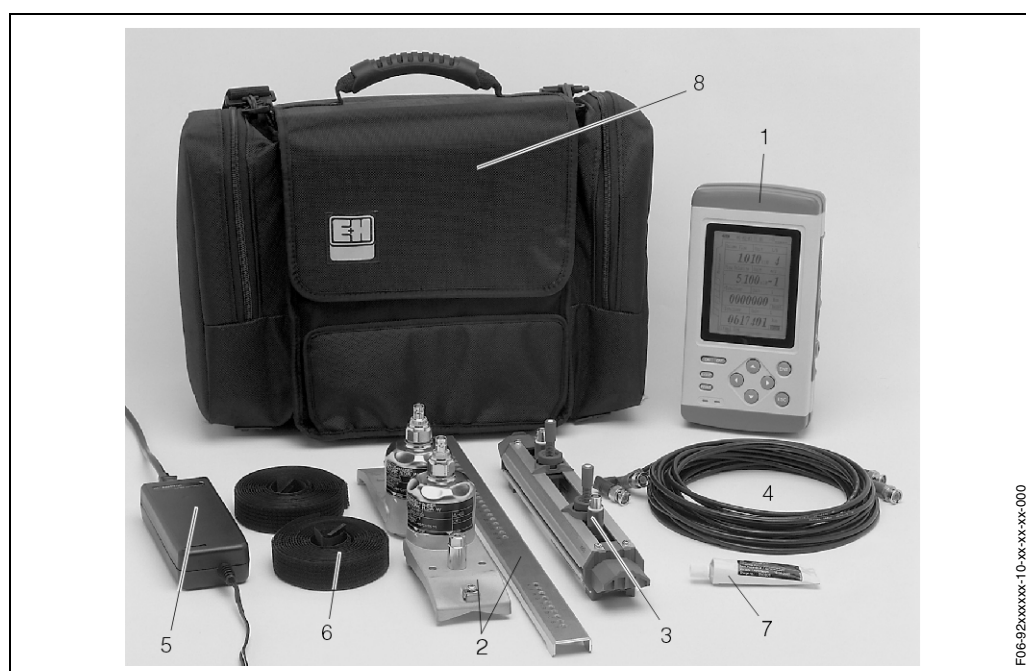
1 = Messumformer Prosonic Flow 92; 2 = Sensoren Prosonic Flow W, Sensorhalterungen und Montageschiene; 3 = Sensoreinheit Prosonic Flow U; 4 = Sensorverbindungskabel; 5 = Netzgerät; 6 = Spannbänder; 7 = Koppelmedium; 8 = Tragtasche
