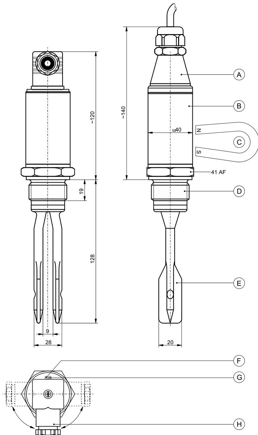
A Электрическое подключение с разъемом и кабельным вводом Pg 11 (IP 65 / 67) или с установленным кабелем (IP 68). Алгоритм срабатывания определяется схемой подключения
