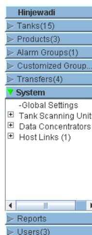
2. На приведенном выше рисунке представлена подсистема Tankvision, а именно модули сканирования резервуаров (NXA820), концентраторы данных (NXA821) и каналы связи с хостом (NXA822). Модули сканирования резервуаров, концентраторы данных и каналы связи с хостом включают все модули NXA820, NXA821 и NXA822 соответственно в этой сети доменов.
