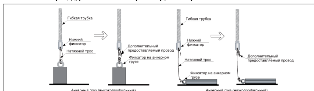
Рис. 16. Монтаж анкерного груза
