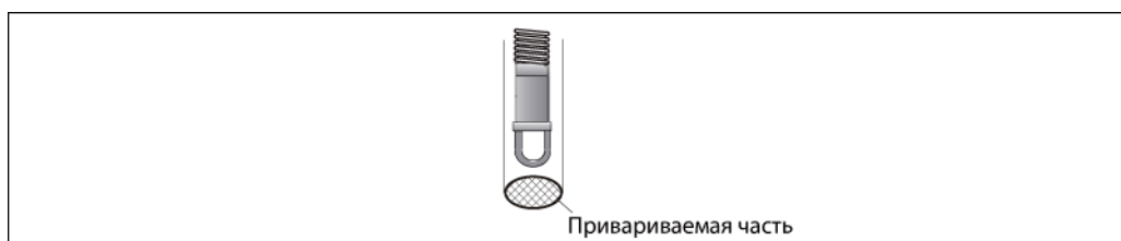
Рис. 21. Привариваемая часть термогильзы
