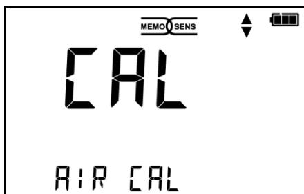
Калибровка измерения кислорода – этап 1 (калибровка на воздухе)
