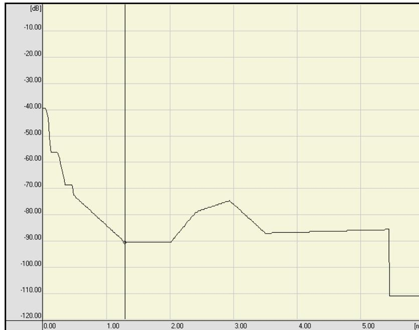
6. ダイアグラムウィンドウ内にカーソルを合わせます。右クリックして、ダイアログボックスから“カーソル下波形の編集 (Ctrl+E)”オプションを選択します。ダイアグラムウィンドウの背景色が“黄色”から“緑”に変わります。これで、ダイアグラムウィンドウ内で波形を編集できる状態になりました。
