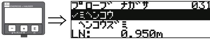
この機能を使用して、工場出荷時の校正の後でプローブ長が変更されたかどうかを選択します。選択した場合に限り、プローブ長を入力または修正する必要があります。
