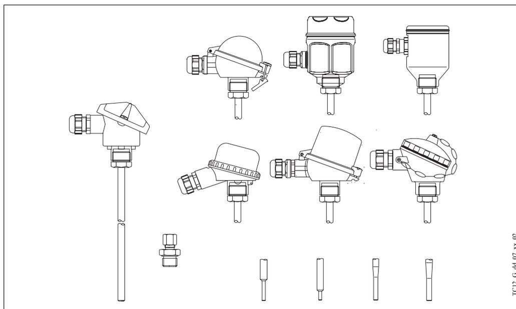
図 1: TC 12 の各種ヘッド、プロセス接続、サーモウエルの先端部分
