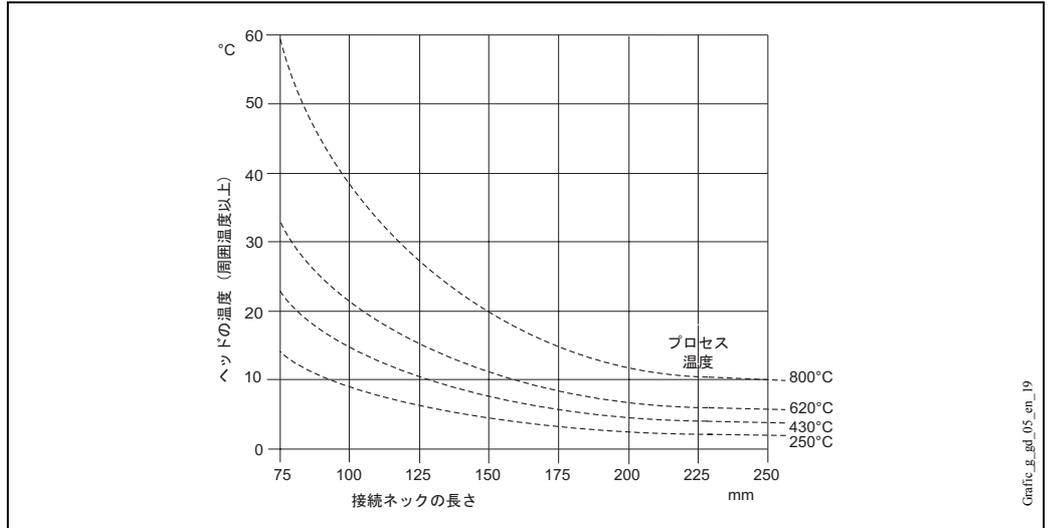
図 5: プロセス温度に伴うヘッド部分の温度上昇
