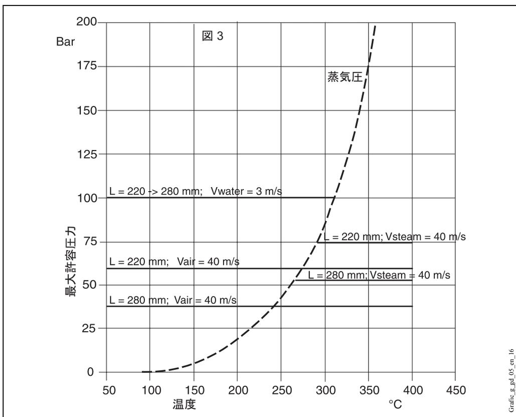
図 3: サーマウエル (テーパ管 12 mm、SUS 316Ti/1.4571) に対する圧力と温度の関係
