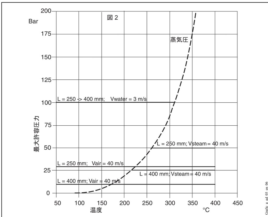
図 2: サーマウエル (ストレート管 11 mm、SUS 316Ti/1.4571) に対する圧力と温度の関係
