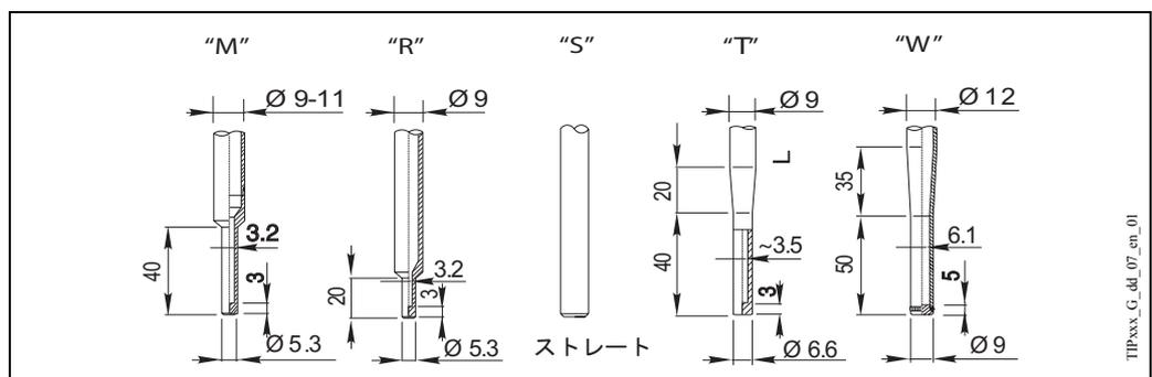
図 10: サーモウエルの先端の形状: ステップ形 (左) とテーパー形 (右)
