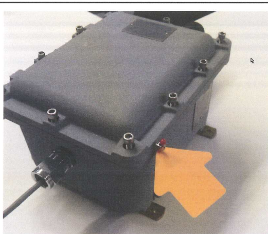
Abbildung 5: Beispiel Siegelstelle Ex geschützter Schutzkasten für die Aufnahme des MultiHop Data Radio
