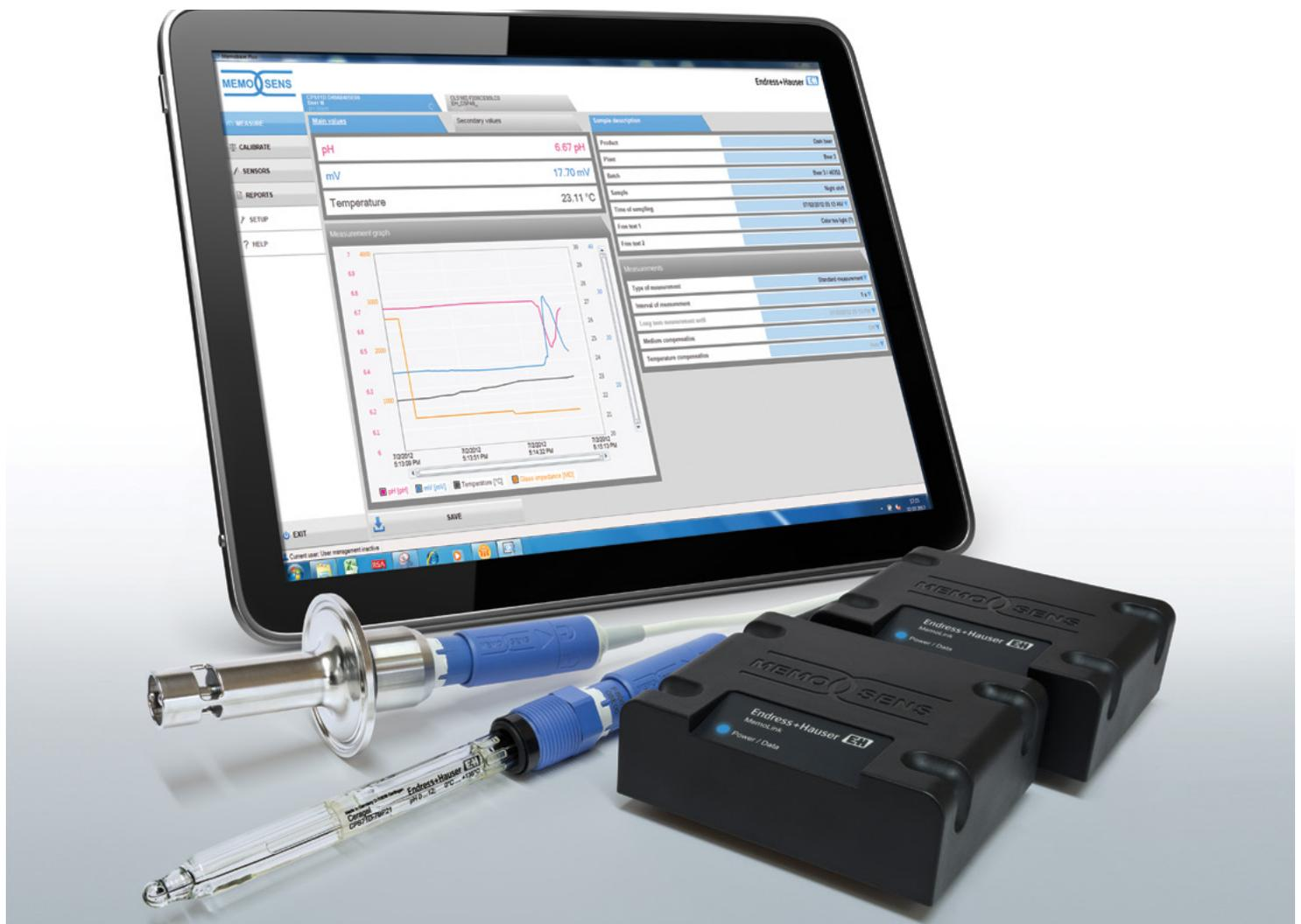
Memobase Plus se compose d'un logiciel associé à une base de données et d'interfaces, permettant de connecter les capteurs utilisant la technologie Memosens sur un PC, sur une simple prise USB.
