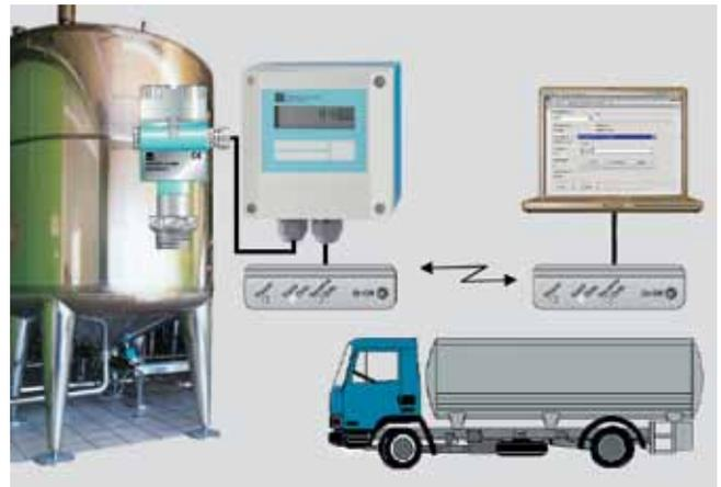
Mesure du niveau de mélasse dans la cuve spécifique d'un fournisseur. Le Minilog B mémorise la consommation du client et informe le fournisseur du niveau effectif dans la cuve de stockage. Les données sont collectées par la centrale d'approvisionnement et sont disponibles pour planifier la livraison en temps voulu.
