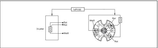
Abbildung 6: Standardanschluss (3-Leiter-Schaltung).
