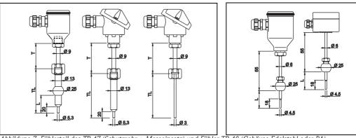
Abbildung 7: Fühlerteil des TR 47 (Schutzrohr + Messeinsatz) und Fühler TR 48 (Gehäuse Edelstahl oder PA).
