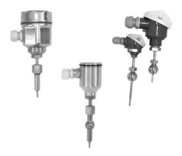
Die Temperaturfühler omnigrad M Typ TR 47 und TR 48 sind Widerstandsthermometer, die speziell für hygienische Anwendungsbereiche (Nahrungsmittel-, Pharma-, Feinchemikalienindustrie) konzipiert wurden. Die Thermometer bestehen aus einem Messeinsatz mit (TR 47) bzw. ohne (TR 48) Schutzrohr und mit einem Anschlusskopf, der den Transmitter für die Umwandlung des Messsignals aufnehmen kann.
